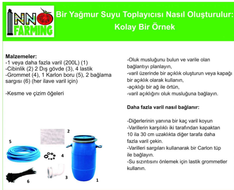
Şekil 10. Bir yağmur suyu toplayıcının gerçekleştirilmesi için adımlar.
